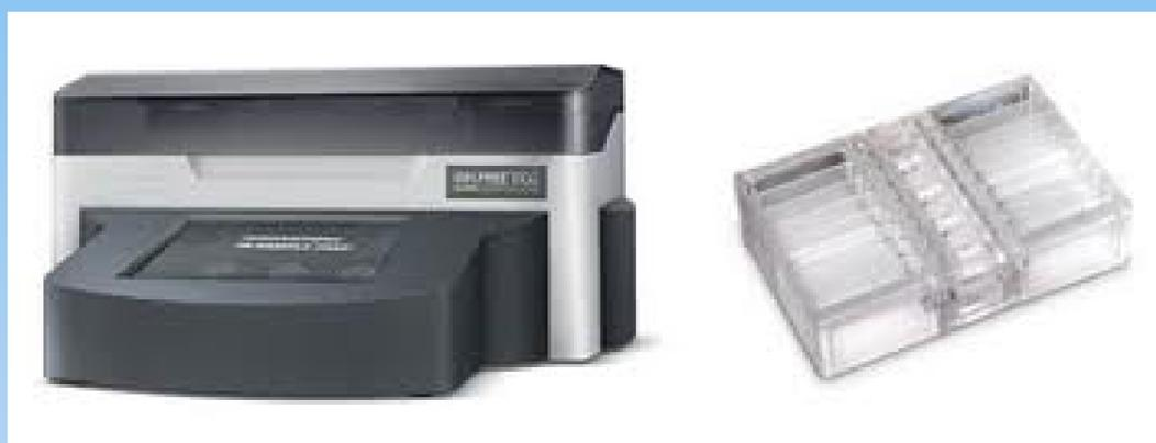
デモンストレーションを行うGELFRR 8100は、分子量ふるいによる分離を行い、ゲルスロットカットや抽出を行う事無く、分離されたタンパクを溶液として回収することが出来ます。回収されるタンパクは溶液中でIntactな状態なので、そのまま容易にELISA、Westen Blotや質量分析用サンプルとして用いることが可能です。質量分析での測定では、Intactおよび酵素消化した試料の解析が可能となります。
